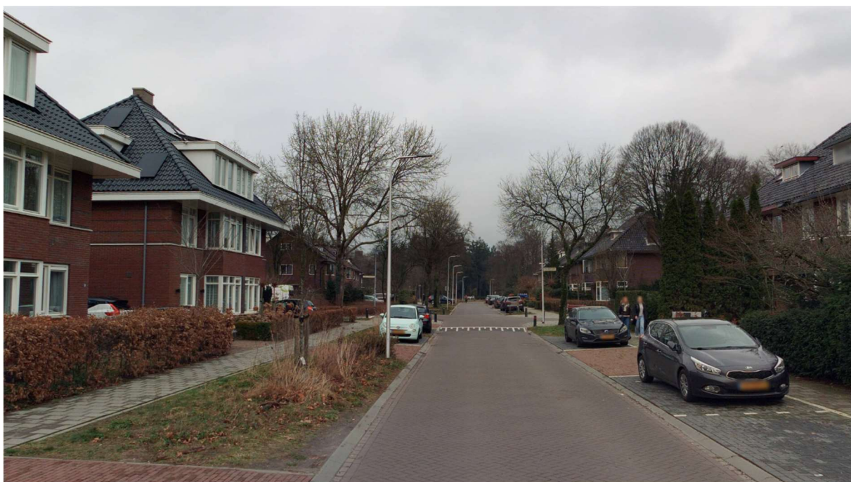
Figuur 7: Sanatoriumlaan, voorbeeld van een erftoegangsweg uitgevoerd in klinkers (bron: CycloMedia).
