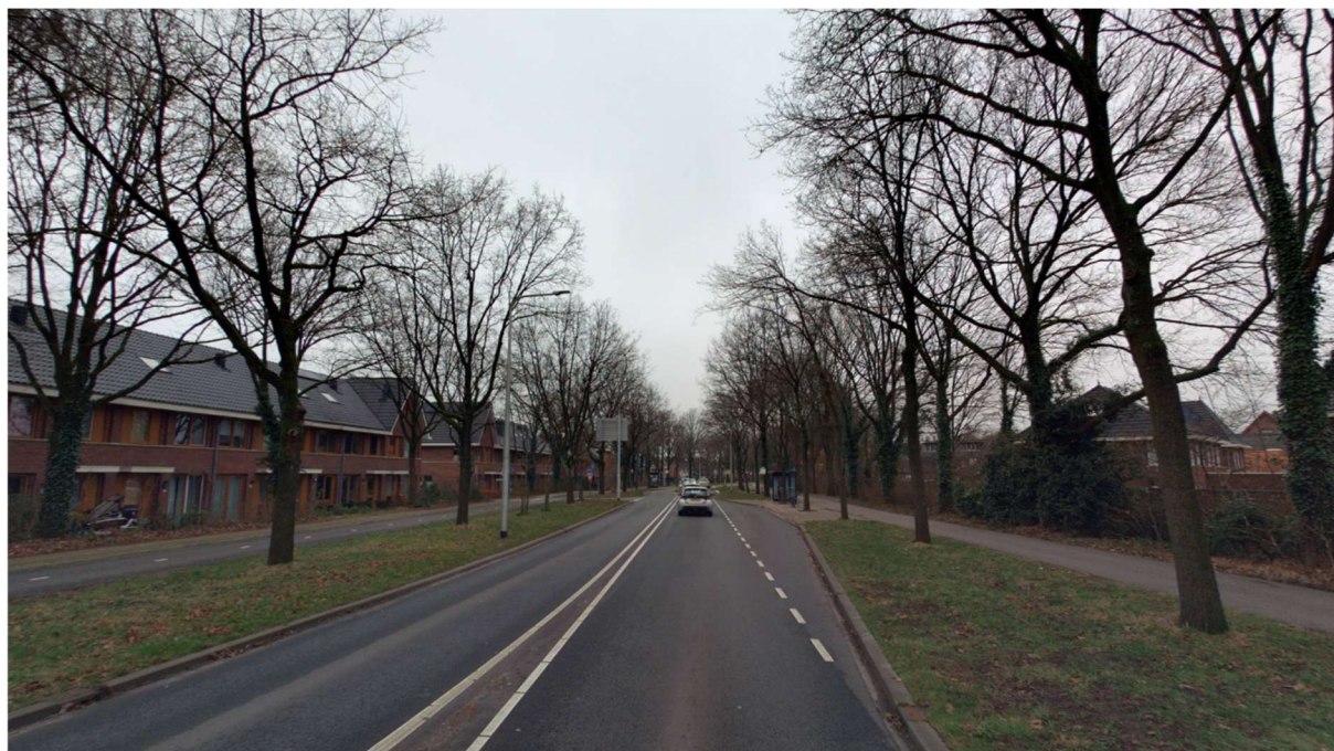
Figuur 2: Kromme-Rijnlaan, voorbeeld van een gebiedsontsluitingsweg met een maximumsnelheid van 50 km/u binnen de bebouwde kom (bron: CycloMedia).
