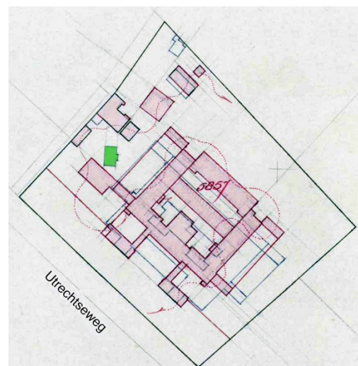
27. Kadasterhulpkaart, Rijkopvoedingsgesticht Eikenstein, Zeist Sectie B, perceelnr. 5857, met in blauw nog de villa die ten behoeve van de nieuwbouw wordt afgebroken en in groen de biljartkamer die behouden blijft als directiekeet voor de bouw van de tuchtschool, 1906; noorden is boven (Kadaster; bewerkt door De Fabryck ).
